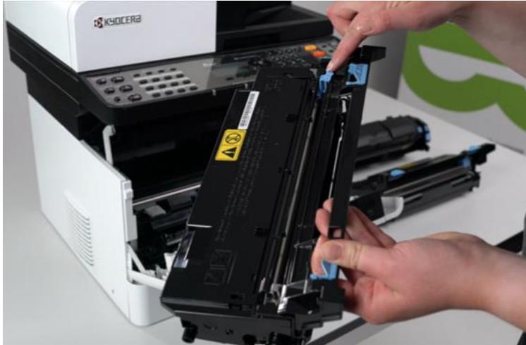
**Hinweis:** Achten Sie darauf, dass der Schieber für den Reinigungsdraht der Trommeleinheit rechts eingerastet ist.
