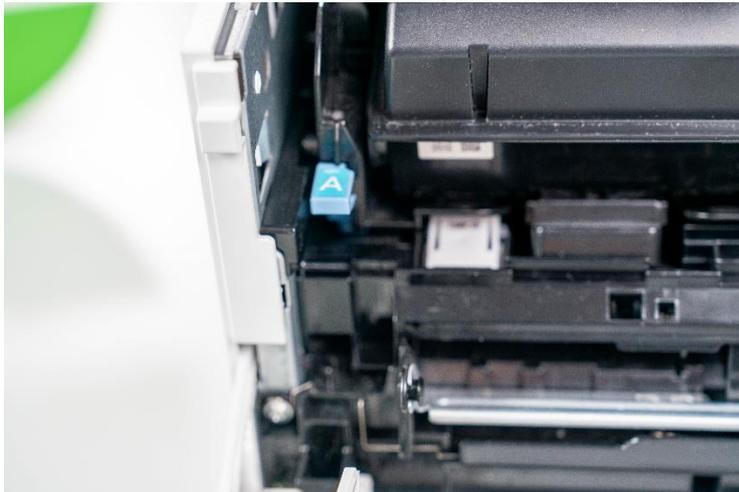
Entfernen Sie nun die dahinter liegende Trommeleinheit, indem Sie diese mit Hilfe des Hebel „B“ zuerst nach vorne und dann nach oben rausziehen. Legen Sie diese ebenfalls auf die vorbereitete Fläche neben dem Drucker.
