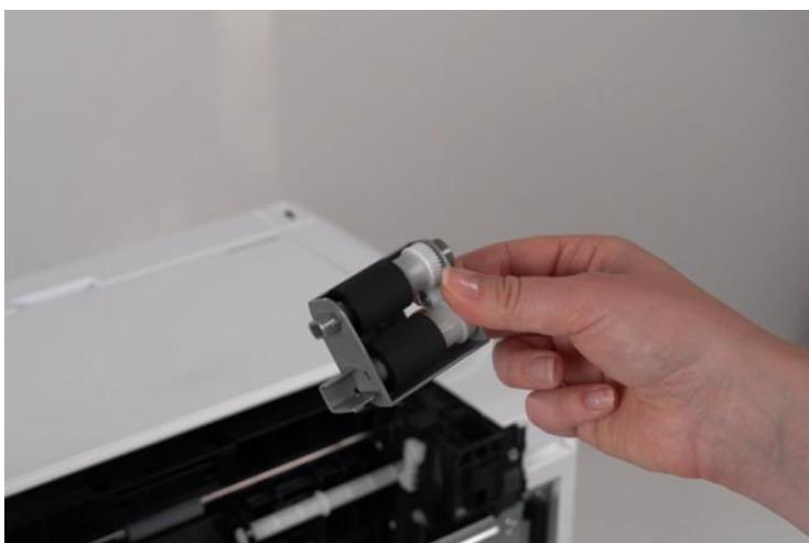
**Hinweis: Falls sich die Pickup-Roller-Halterung nicht direkt auf die Antriebsachse aufsetzen lässt, drehen Sie an der oberen Rolle, um die Position anzupassen.**
