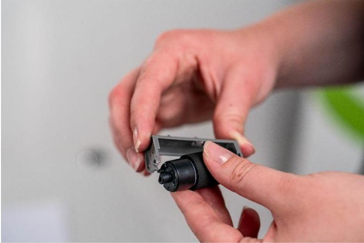
**Hinweis: Vorsichtig die Gummirolle aus dem Innenteil lösen, indem das Gehäuse etwas aufgebogen wird.**
