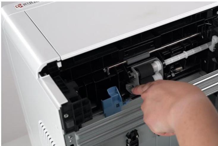
Klappen Sie die gesamte Pickup-Roller-Halterung herunter. Drücken Sie dafür den Haken auf der linken Seite der Pickup-Rollen-Halterung, um diese im 90 Grad Winkel nach unten zu klappen. Schieben Sie im Anschluss die Pickup-Roller-Halterung nach links, bis sich diese von der Antriebsachse lösen lässt. Nun können Sie dieses Teil nach vorne unten entfernen.
